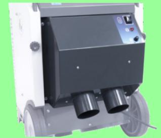
**Kondensatpumpe:** Mit der für alle Modelle erhältlichen Kondensatpumpe kann das Kondenswasser bis zu einem Höhenunterschied von 5 m zwischen Gerät und Wasserablauf abgepumpt werden.
